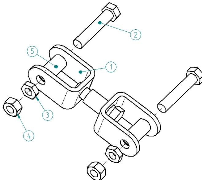
3-C-Engager la bride(1) (sans les vis et les écrous) de l'AmarSecur Chaîne sur un maillon de chaîne ou tout autre organe de fixation adapté, sans oublier le galet de rotation (3), et insérer ensuite la vis (2) de la manière suivante (traiter une chaîne après l'autre) :
