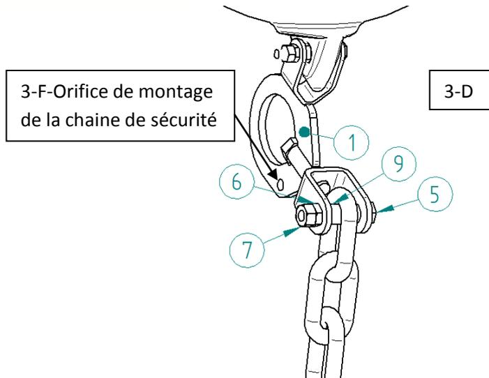
F - Le montage de la chaîne de sécurité au bateau par maillon rapide est une option que nous recommandons de mettre en place. Il est réalisé par la présence de l'orifice présent sur la bride (1).
