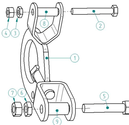
**3-B-** Engager la bride(1) (sans les vis et les écrous) de l'AmarSecur Bouée sur votre bouée, anneau de bouée ou élément de fixation de bouée sans oublier le galet de rotation (8) de la manière suivante:
